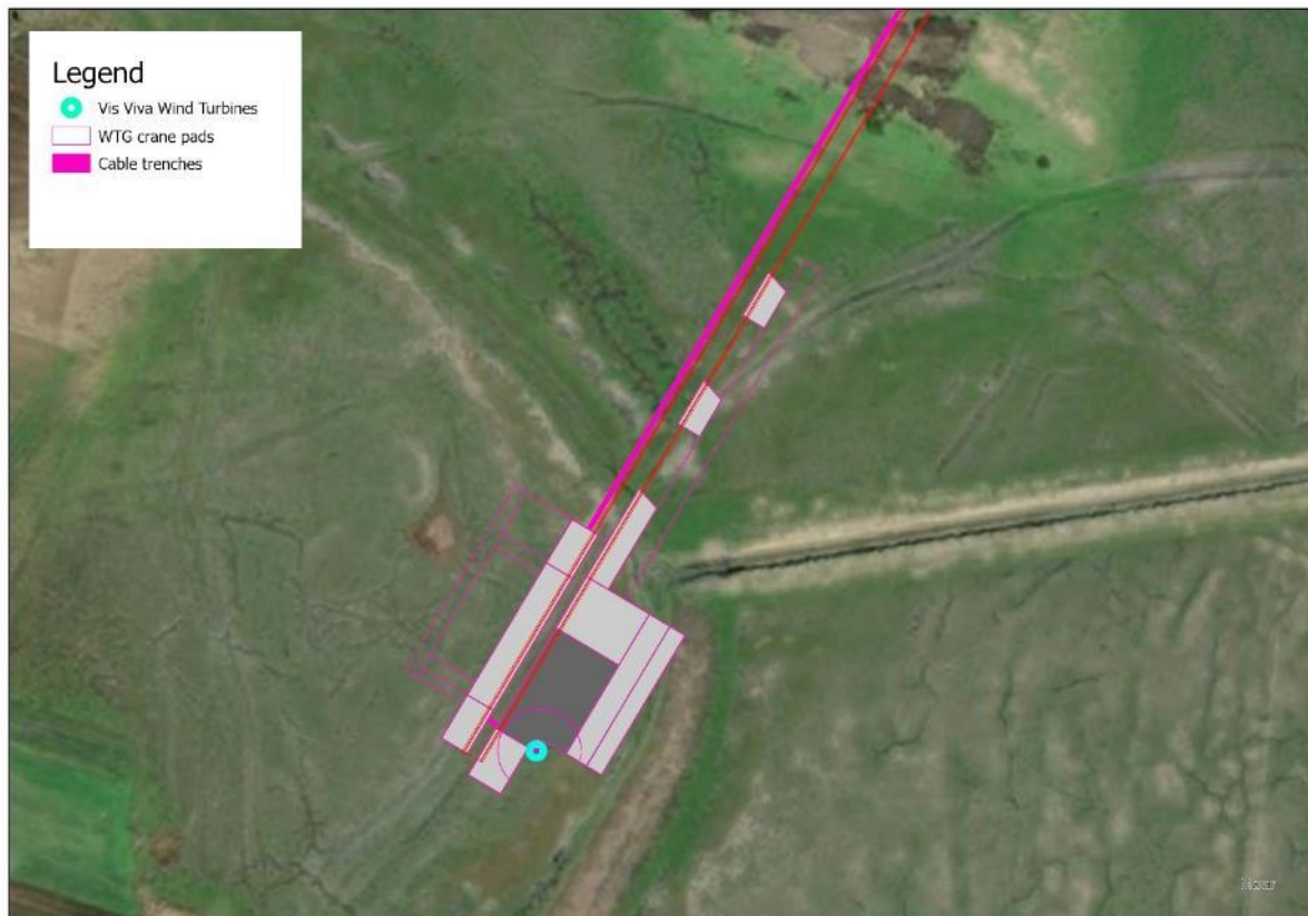
Figura 2-4 GTE tipice și platforme de lucru asociate
